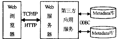
图 5 基于第三方的 Metadata 网络管理模型结构图 Fig. 5 Architecture of Metadata Network Management Model Based on Third Vendor's Software
